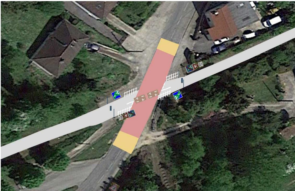
Exemple de principe de traitement d'une intersection entre une RD et une voie verte (Caours)
